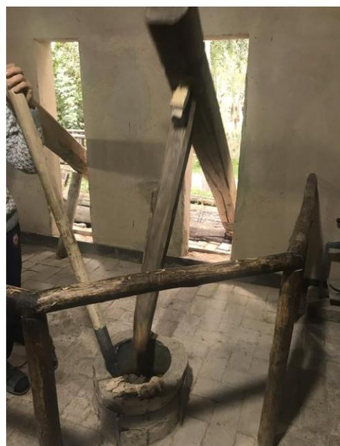
工房の外にある水車の動力を利用したビーター（叩解機）
